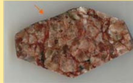
^{14}\text{C} -PMMA impregnoidusta kairasydämeestä tehty pintahie
