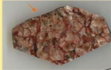
^{14}\text{C} -PMMA impregnoitusta kairasydämeistä tehty pintahie
